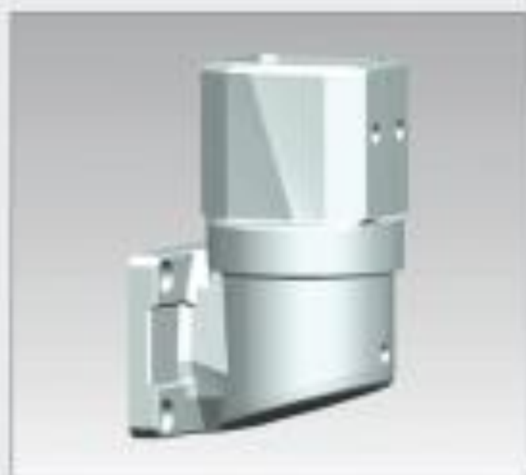
品名：垂直牆座 订货号：44-60-10-60 重量：1.17kg 材料：压铸铝合金 可水平旋转0-320°
